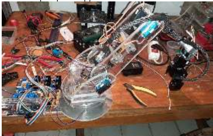
Εικόνα 1: Ο ρομποτικός βραχίονας σε φάση κατασκευής και δοκιμών.
