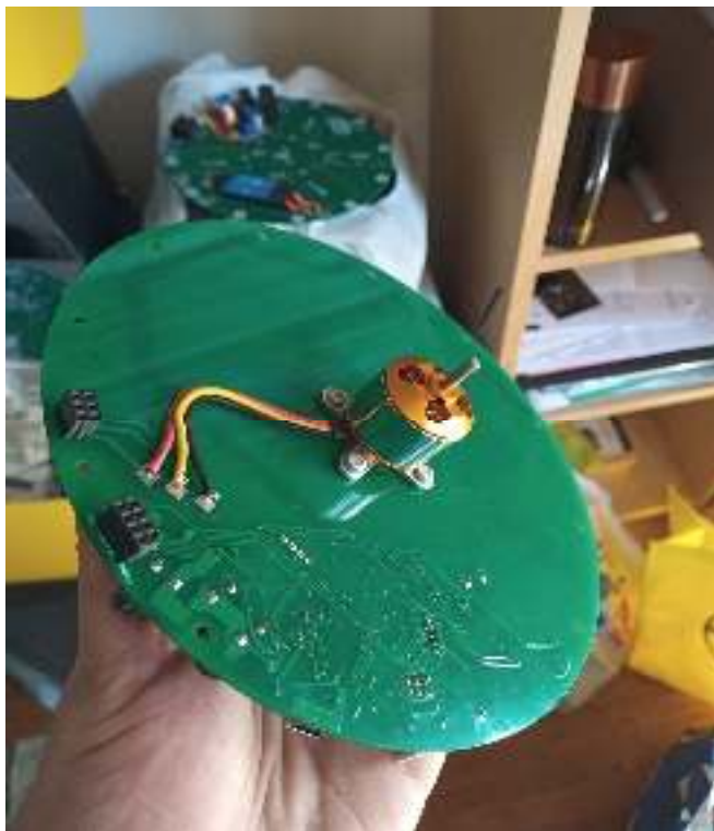
Εικόνα 5: Ο ηλεκτροκινητήρας στο μέσο της επάνω πλακέτας
