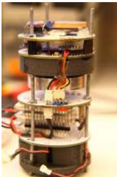
Εικόνα 1: Το CanSat της ομάδας μας. Διακρίνεται ο μεταλλικός δίσκος για την σταθεροποίηση
