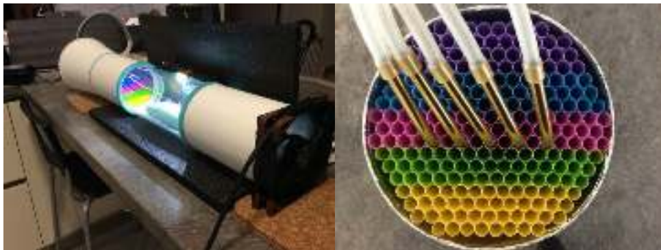
Εικόνα 4: Δομή εσωτερικών σωλήνων (χρωματιστά πλαστικά καλαμάκια) και σωλήνων καπνού (μεταλλικά καλαμάκια)
