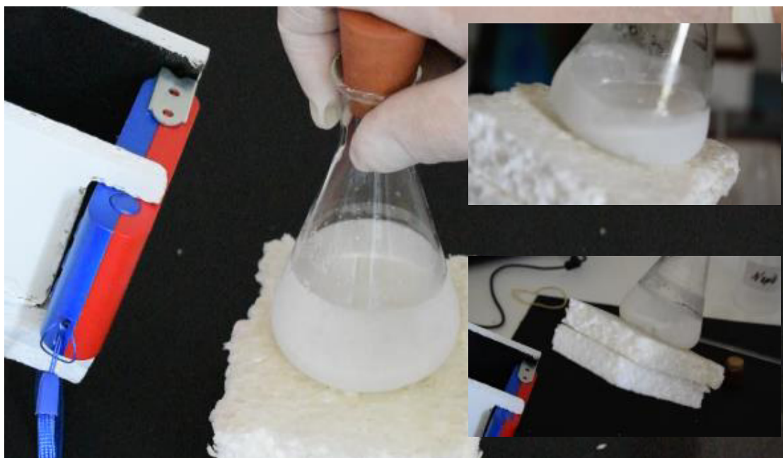
Εικόνα 15: Η περιοχή του πωθμένα της κωνικής φιάλης είναι τόσο ψυχρή, ώστε παγώνει τις σταγόνες νερού, που τοποθετήσαμε στην βάση από φελιζόλ. Κατά συνέπεια η βάση προσκολλάται στην φιάλη!
