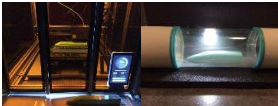
Εικόνα 6: Εκτύπωση μοντέλου τρένου με 3D printing και ροή καπνού εντός της αεροδυναμικής σήραγγας
