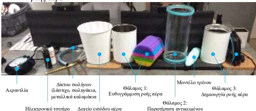
Εικόνα 2: Τα δομικά μέρη της αποσυναρμολογημένης αεροδυναμικής σήραγγας
