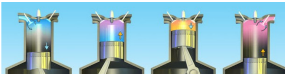
Εικόνα 1: Οι θέσεις ενός εμβόλου μηχανής στον κύκλο ενός τετράχρονου κινητήρα
